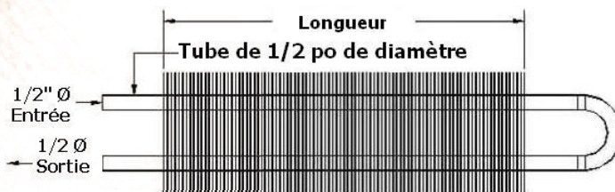
Configuration des tubes en serpentine ("loop")
