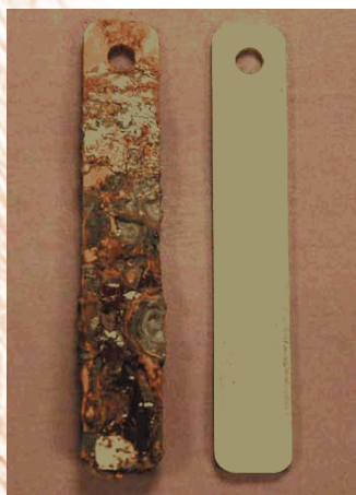
Le coupon de corrosion de droite atteste de l'efficacité de l'inhibiteur de corrosion volatil ICV sur un élément de tour de refroidissement en un milieu humide.
